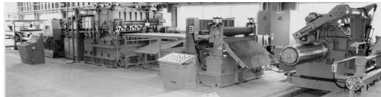
写真1 ステンレスの3mm×1300幅レベラーシャーライン
