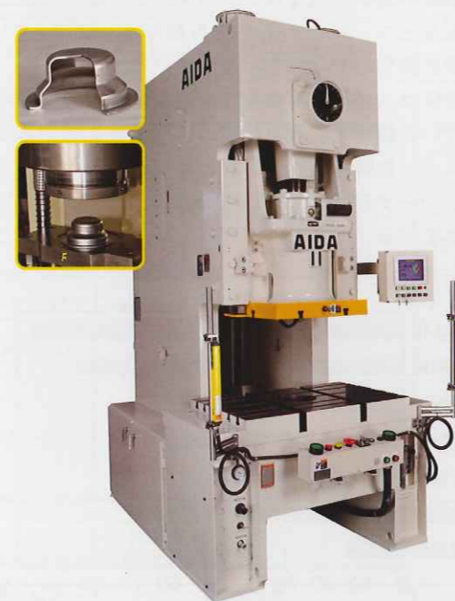
写真1 Simple / Ecology 機能を組み込んだ「サーボ化改造システム」
