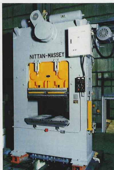
写真2 4ポイントサスペンション ワイドラムトリミングプレス
