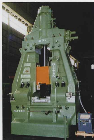
写真3 ニットンエアードロップハンマー
