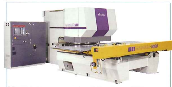
写真3 5' x 10' 材対応のタレットパンチプレス「MAGNUM」
