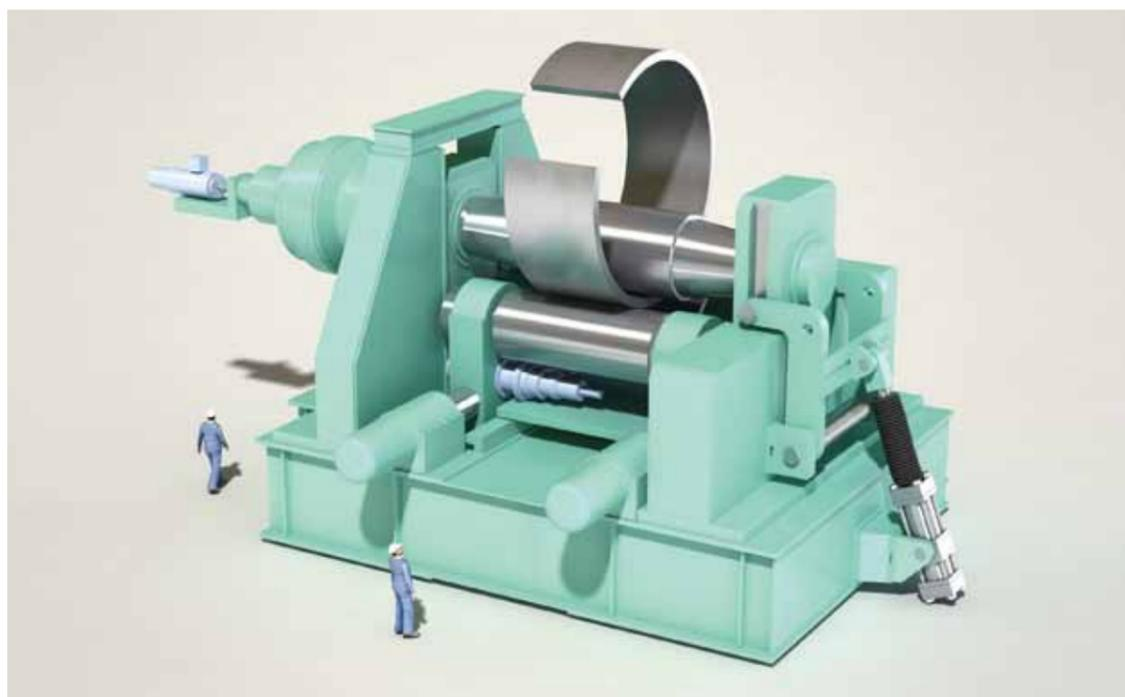
写真1 世界最大の曲げ能力を持つ、15000トン超大型ベンディングロール
