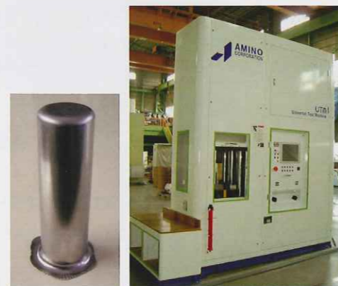
写真3 万能塑性加工試験機 UTM & 消火器工程成形例
